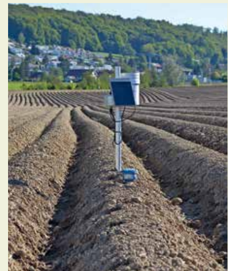
Les sondes souterraines permettent d'optimiser l'irrigation des pommes de terre.
